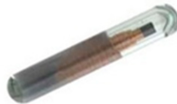
Figura 36. Um PIT é um microchip dentro de uma pequena cápsula de vidro estéril que pode ser injetada com uma seringa.
