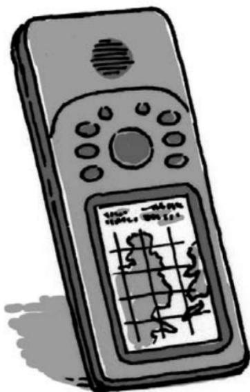
**Le GPS permet de localiser avec précision l'endroit où l'on se trouve.** C'est un récepteur de radio-positionnement qui fonctionne avec des signaux émis par des satellites. Il est indispensable à bord d'une embarcation de surveillance d'AMP car il sert à connaître précisément les points d'arraisonnement de navires, les limites de l'AMP, les points de prélèvement ou de contact avec des espèces, etc...
