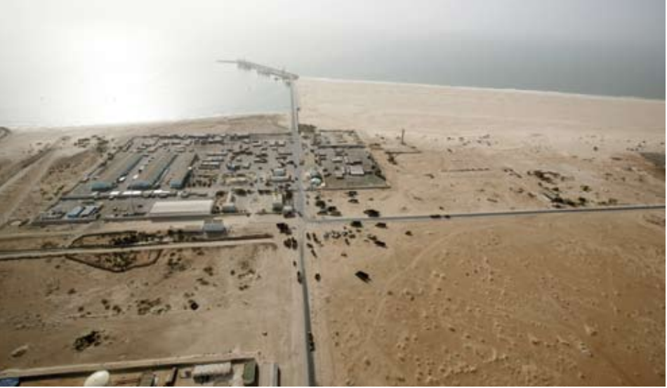
Le port de Nouakchott vu d'avion : on voit ici que le port, en barrant l'écoulement naturel des courants, a modifié le profil du littoral
